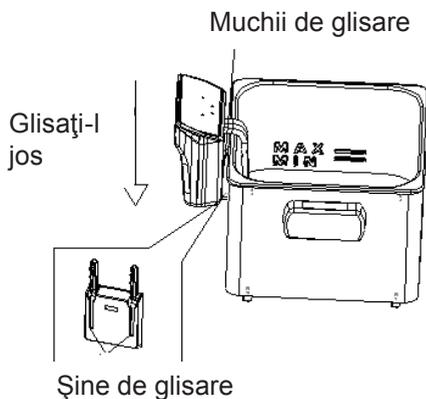
3. Glisați conductorii aflați pe unitatea de comandă a friteuzei pe conductorii aflați pe corpul aparatului. Mențiune! Înainte de asamblarea unității de comandă, recipientul de ulei trebuie introdus în corpul aparatului.
