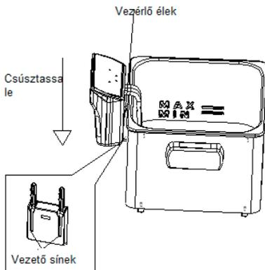
3. Csúsztassa a sütő vezérlőjén található vezetöket a készülék házon található vezetökre. Megjegyzés: A vezérlö összeszerelését megelőzően az olajtartályt a készülék házba kell helyezni!
